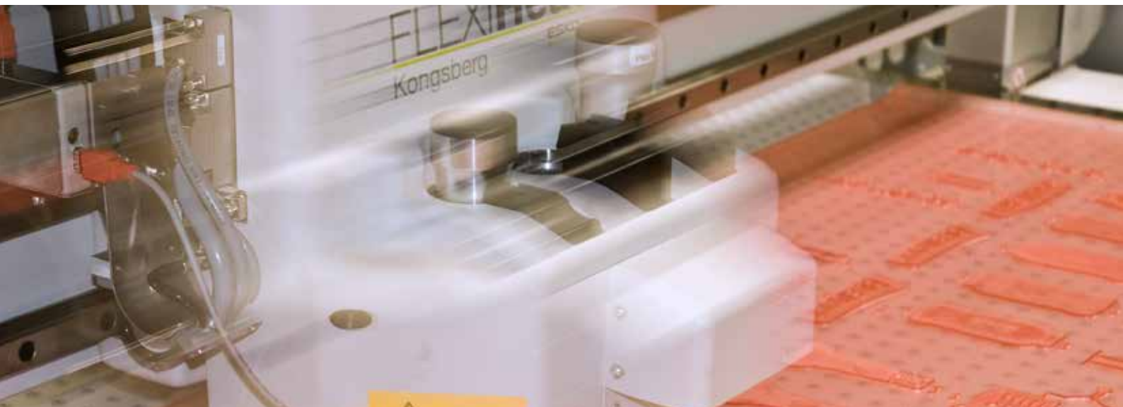
I tavoli di taglio digitale Kongsberg tagliano le lastre flessografiche in maniera rapida e precisa.
